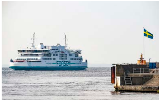
Under det nya namnet Forsca skedde 2018 en miljösanering genom att två av färjorna som trafikerar Helsingborg-Helsingör byggdes om till elldrift med batterier som snabbaddas i hamn.
